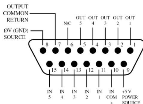
Figura 1-4: Pines de salida del Conector GPIO
