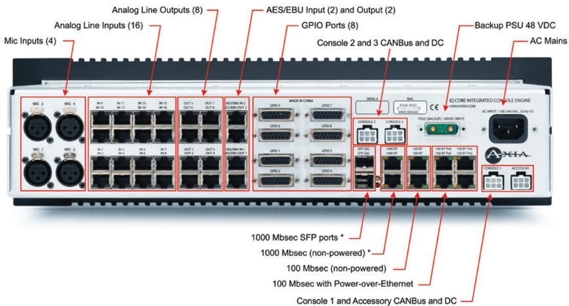
Figura 1-2: QOR.32 – Conexiones del panel trasero
