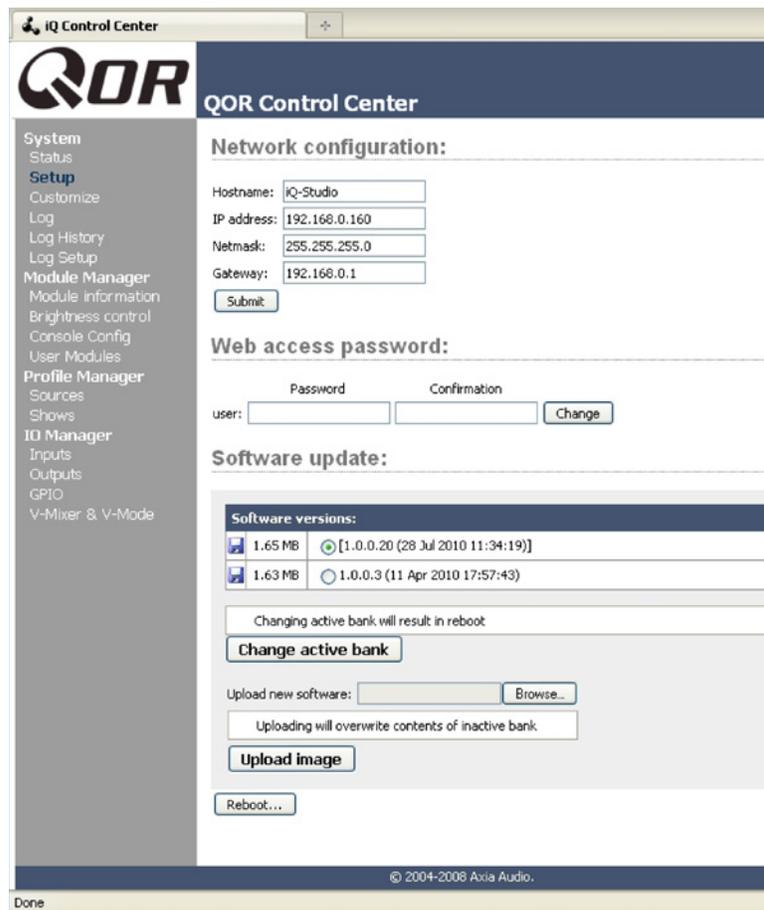
Figura 6-2: “Setup Screen” Pantalla de Configuración
