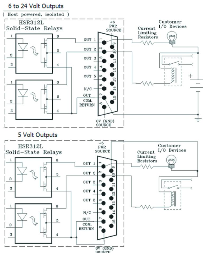
Figura 5-5: GPIO Conexiones de Salida
