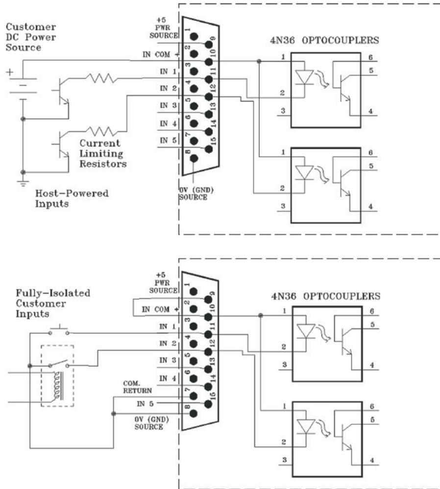
Figure 5-4 GPIO Conexiones de Entrada
